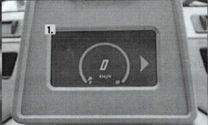
1. Display LCD com velocímetro e indicadores de acionamento das luzes dianteiras e de direção.
